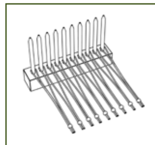
obr. 5: svázání osnovních provázků
