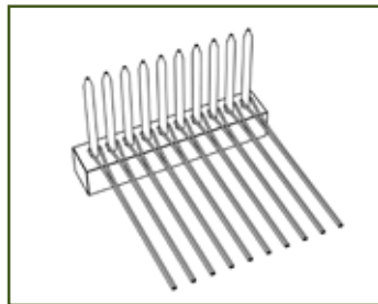
obr. 2: osnovní provázky se navlékají dvojité
